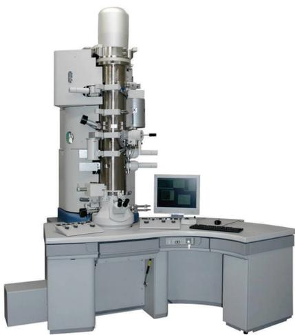
1) Transmissions-Elektronenmikroskop der Firma Hitachi
